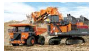
日立建機の鉱山用超大型油圧ショベルとダンプトラック
